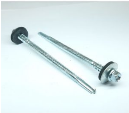
Skrutka samovrtná pre sendvičové panely, prevrtanie do 6 mm s Al podložkou EPDM - 6.3/5.5 x 180
