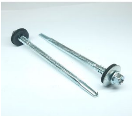
Skrutka samovrtná pre sendvičové panely, prevrtanie do 6 mm s Al podložkou EPDM - 6.3/5.5 x 280
