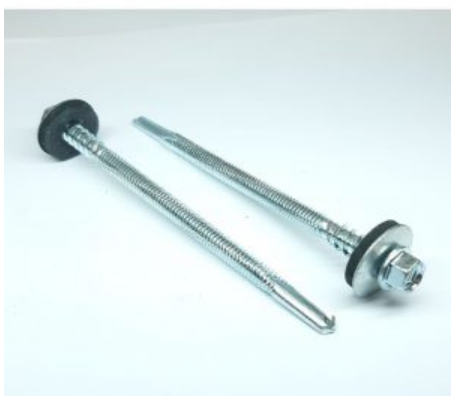
Skrutka samovrtná pre sendvičové panely, prevrtanie do 6 mm s Al podložkou EPDM - 6.3/5.5 x 210
