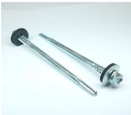
Skrutka samovrtná pre sendvičové panely, prevrtanie do 12 mm s Al podložkou EPDM - 6.3/5.5 x 80
