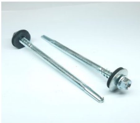
Skrutka samovrtná pre sendvičové panely, prevrtanie do 6 mm s Al podložkou EPDM - 6.3/5.5 x 160
