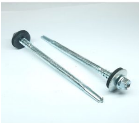
Skrutka samovrtná pre sendvičové panely, prevrtanie do 6 mm s Al podložkou EPDM - 6.3/5.5 x 230
